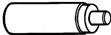
Y.20082 Schläger für Lagerbuchse Outil d'extraction et de pose pour étui à rouleaux Drift for needle bearing
