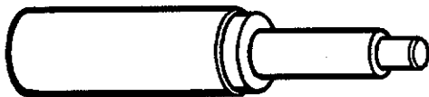
Y.20081 Schläger für Lagerbuchse Outil d'extraction et de pose pour étui à rouleaux Drift for needle bearing
